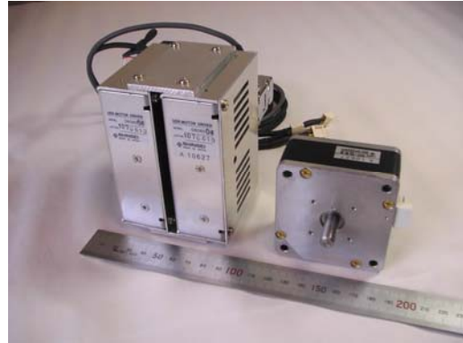
図2 ロボットスーツで使用されている 超音波モータ
