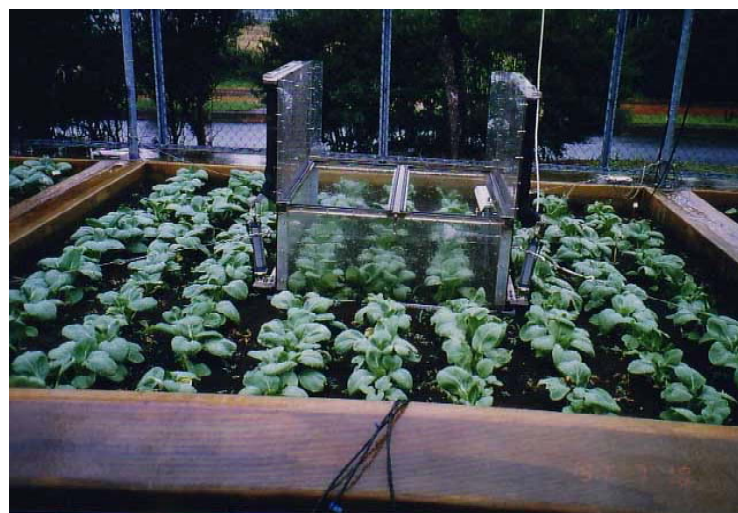
写真 農耕地からの温室効果 ガス発生量の自動連続測定装 置
