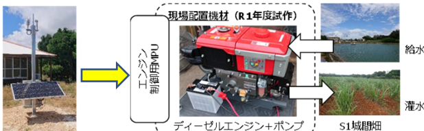
微気象ポストの情報で灌水のオンオフを決定。
