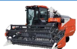
収量センサ付き自動運転コンバイン
