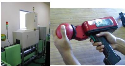
JAおきなわに導入された糖度センサー（左）とハンディ型糖度センサー（右）
