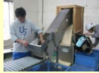
サトウキビ専用の細裂装置
