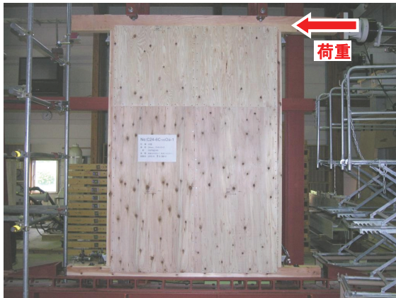
実大耐力壁試験の様子
