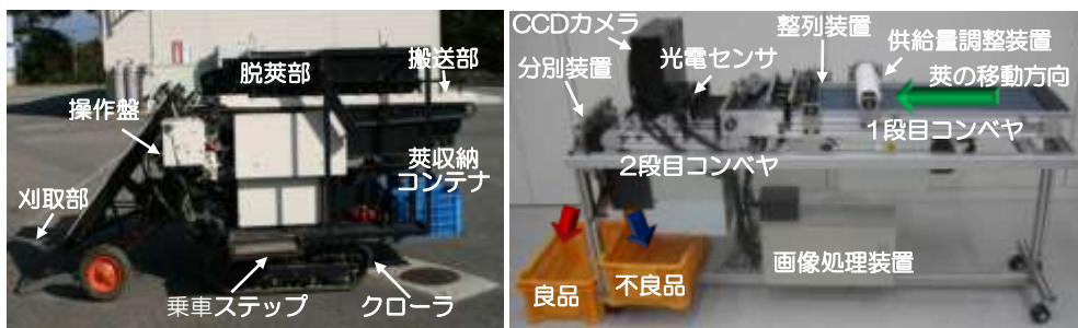
■エダマメ収穫脱莢機(エダマメコンバイン) 10aを4時間で収穫、脱莢精度87%
