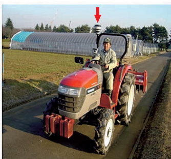
トラクターに搭載し、農作業中の気象データを収集
