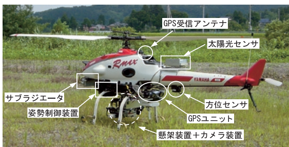
図7 無人ヘリ搭載式作物生育情報測定装置
