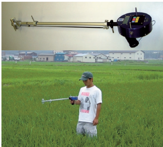
図6 携帯式作物生育情報測定装置の概観（上）と測定風景（下）
