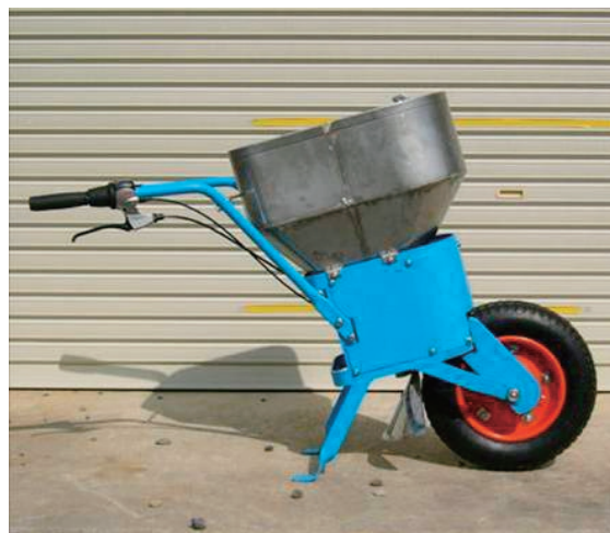
図 11 速度連動式歩行型施肥機 手押し速度にかかわらず一定量の肥料散布を実現。
