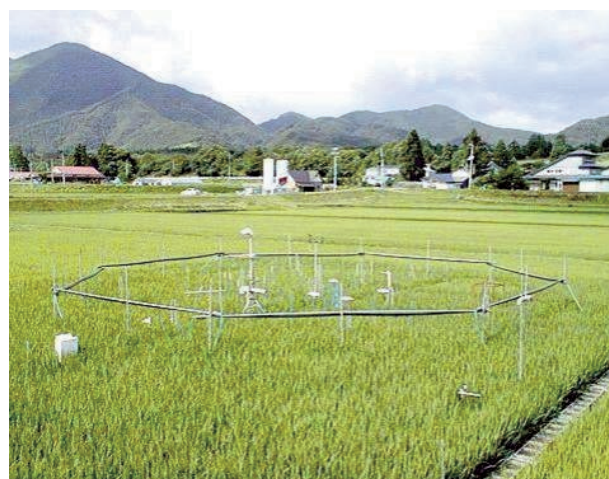
図9 将来のCO 2 増加の影響を研究する岩手県雫石町のイネFACE実験
