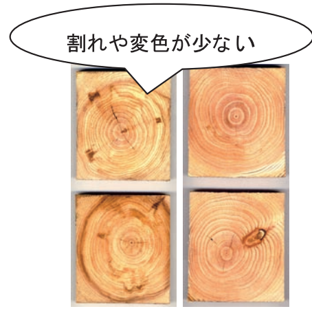
図14 高温過熱蒸気・減圧併用乾燥の処理条件（上）と仕上がり（下）
