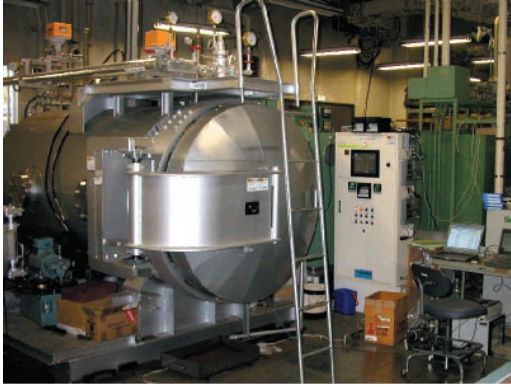
図12 開発した過熱蒸気式木材乾燥装置 *過熱蒸気として、100℃以上で常圧より高い圧力を持ち、かつ飽和温度より高い温度の蒸気を使います。
