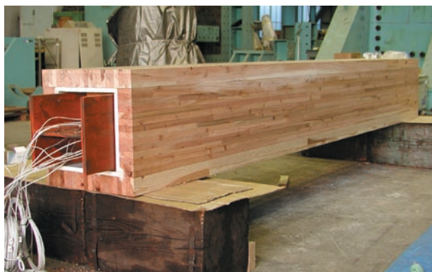
図 30 鋼材をスギ集成材で被覆した複合構造材
