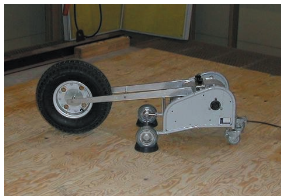
図 22 床の遮音性能試験 (重量衝撃音)
