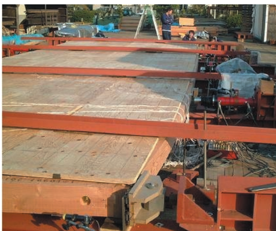
図 21 実物大床の耐震試験 (横から加力)
