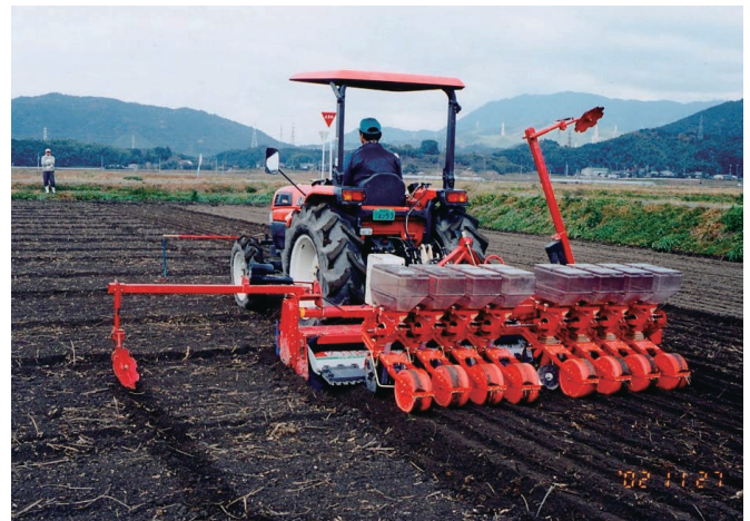
図3 ショットガン播種機による水稻直播作業（左）と改造機による麦播種作業（右）
