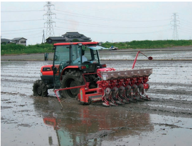
図3 ショットガン播種機による水稻直播作業（左）と改造機による麦播種作業（右）
