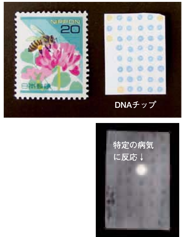
図21 魚貝類細菌性疾患診断DNAチップと診断例 ((独) 水産総合研究センター養殖研究所 大迫 典久氏 提供)
