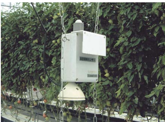
写真7 温室内の情報を収集し送信するグリーンナビシステム
