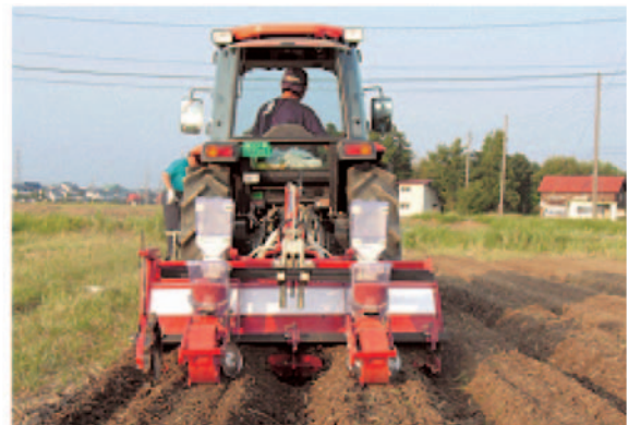
写真6 重粘土圃場向けに開発された改良型アップカッターロータリを装備した畝立て・施肥・播種同時作業機
