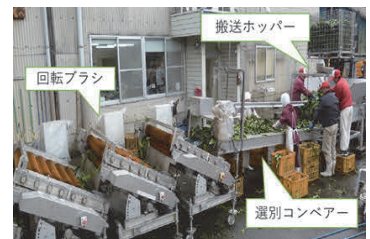
機械収穫物受入工程
