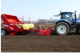
複数作業機のワンマン・オペレーション
