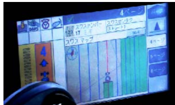
GNSSガイダンスシステムを利用した夜間作業
