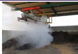
攪拌作業時の臭気の発生
