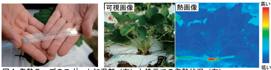
図1 発熱テープのスポット加温部（左）と株元での発熱状況（右）
