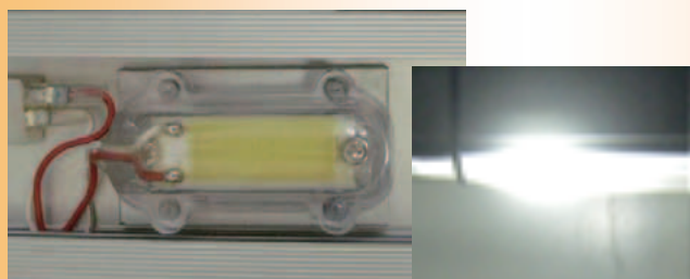
写真2 白色LED照射装置
