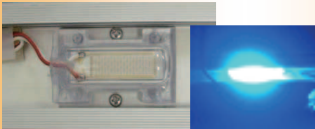
写真1 青色 LED 照射装置
