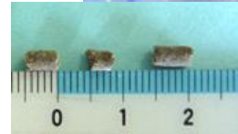
窒素付加鶏ふん微小ペレット肥料 水稲側条施肥機で散布可能
