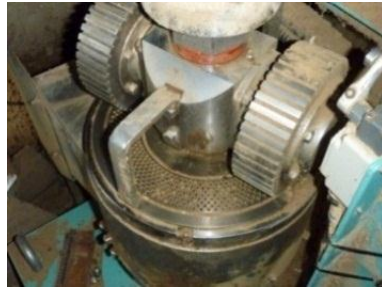
造粒 孔径3mmのディスクで成型
