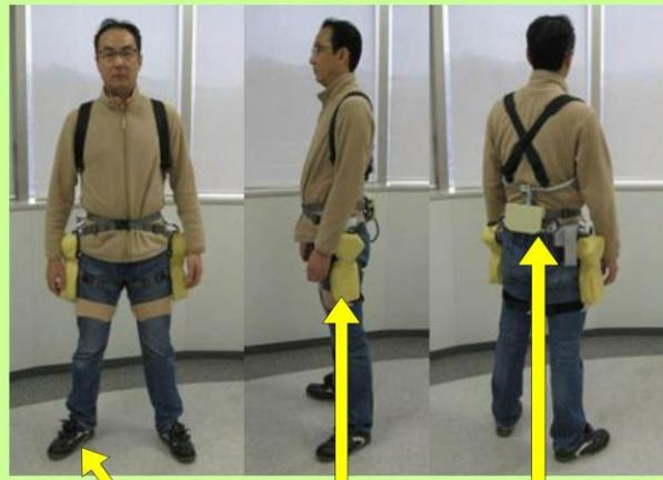
靴底にかかる力の変化を計測するセンサ搭載
