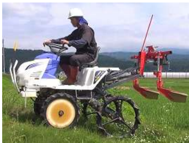
後輪昇降機構により傾斜面 も安心して運転できる
