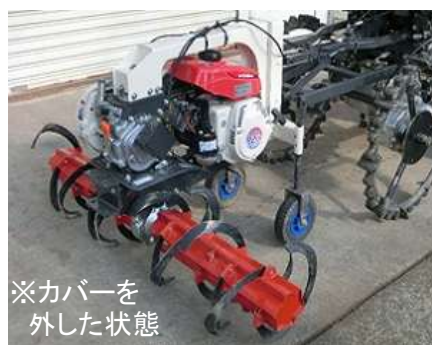
後輪昇降機構により傾斜面 も安心して運転できる
