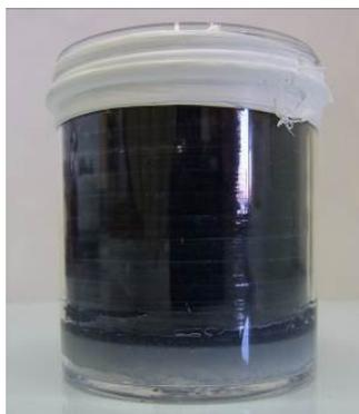
図3 プルシアンブルーナノ粒子を付着させた不織布をU8容器に充填した溶存態セシウム吸着用容器
