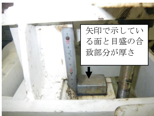
図3 厚さ調整確認部分
