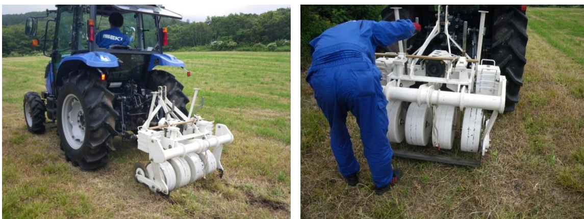
図2 トラクターに装着した状態（左）と切り取り厚の調整風景（右）
