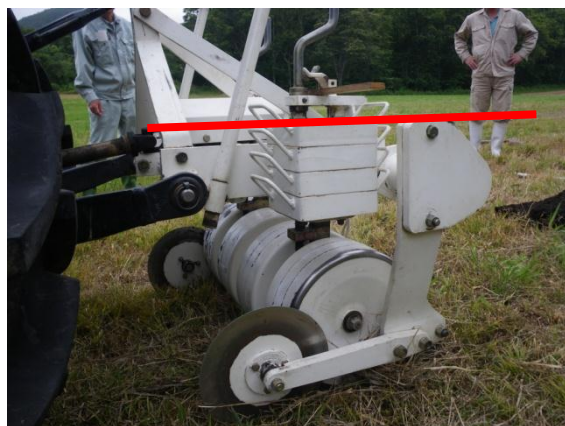
図5 刃の角度の調整
