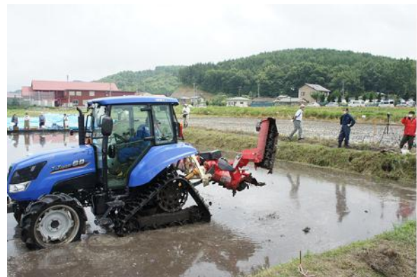
図4 ドライブハローによる浅代かき状況（入水後）
