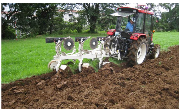
図1 はつ土板プラウによる反転耕
