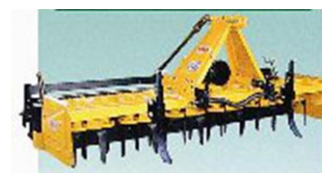
図 9 バーチカルハロー 6)
