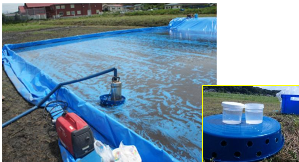
図8 凝集剤による固液分離状況（右下は上澄み液）
