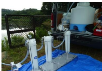
図6：クラウンエーテル捕集材によるセシウム吸着構造（左）とセシウム除去処理装置（中：プレフィルター、右：トルネード吸着塔）
