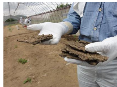
写真5：ポリオンにより固化した土壌
