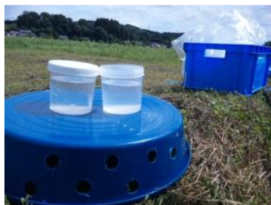
写真4：固液分離後の上澄み液 (放射性セシウム濃度は検出限界以下)
