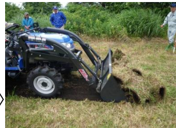
フロントローダを用い、すくい上げによる搬出する。
