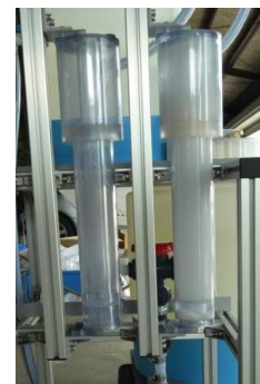
図6：クラウンエーテル捕集材によるセシウム吸着構造（左）とセシウム除去処理装置（中：プレフィルター、右：トルネード吸着塔）
