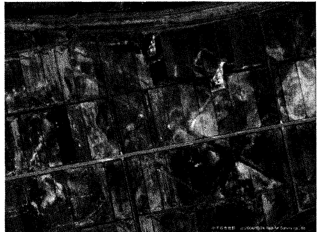
写真2 小千谷市岩野の液状化被害状況 (撮影:アジア航業株) 地震時液状化による噴砂が直線状・格子状に分布している。直角格子状のパターンは、ほ場整備前の水田の区画を反映したものの。
