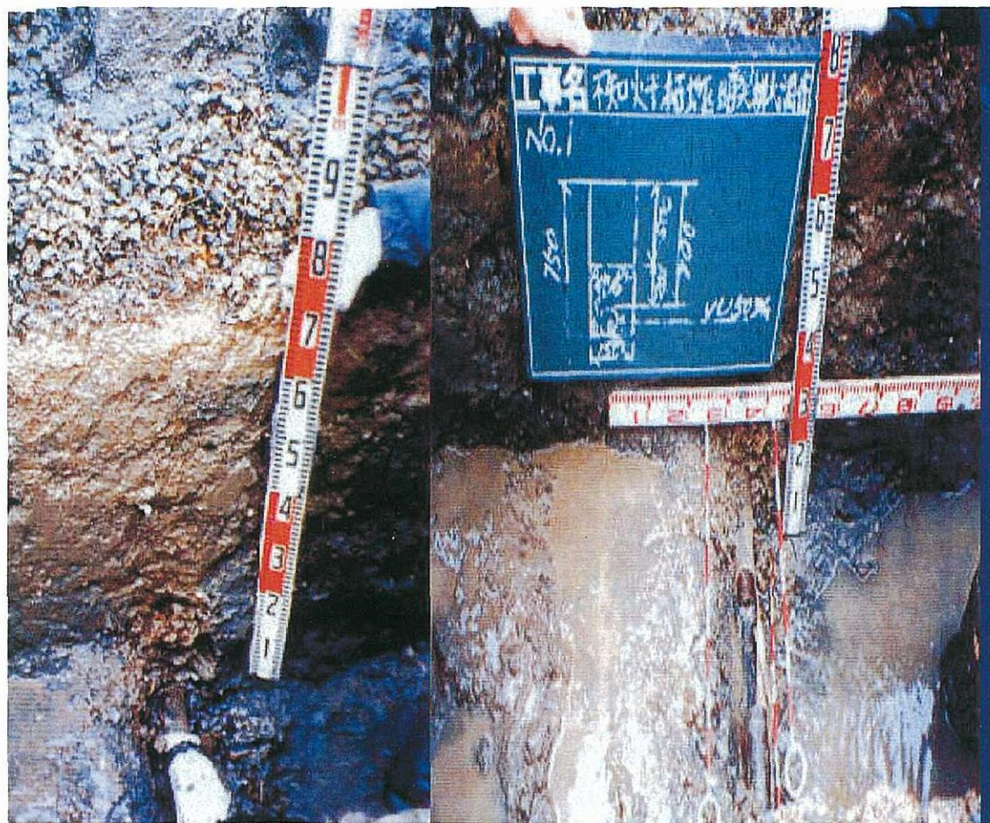
图4-4 不知火干拓现地暗渠断面图
