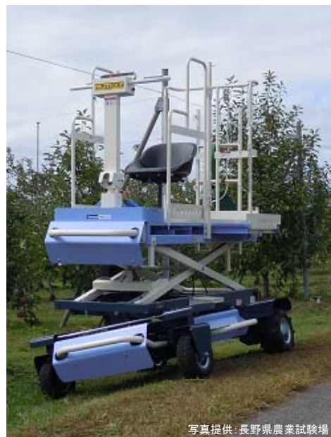
高機動型高所作業台車 作業台部は自動で水平制御
