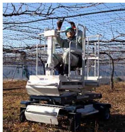
座席を装着し棚栽培果樹園で座って作業
