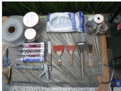
補修作業に使用する道具類
