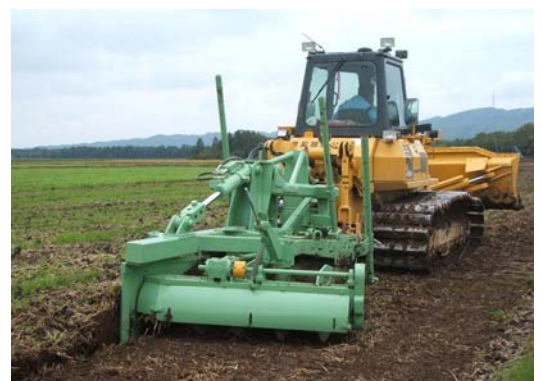
カッティングソイラ工法の施工機
