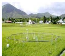
開放系CO<sub>2</sub>増加装置による高温・高CO<sub>2</sub>の影響評価、対策技術の開発
