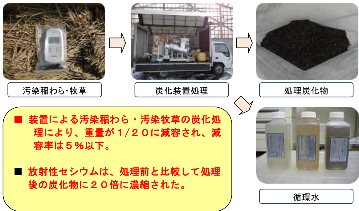
【 図1 装置による汚染稲わら・汚染牧草の減容化と放射性物質の分配 】
