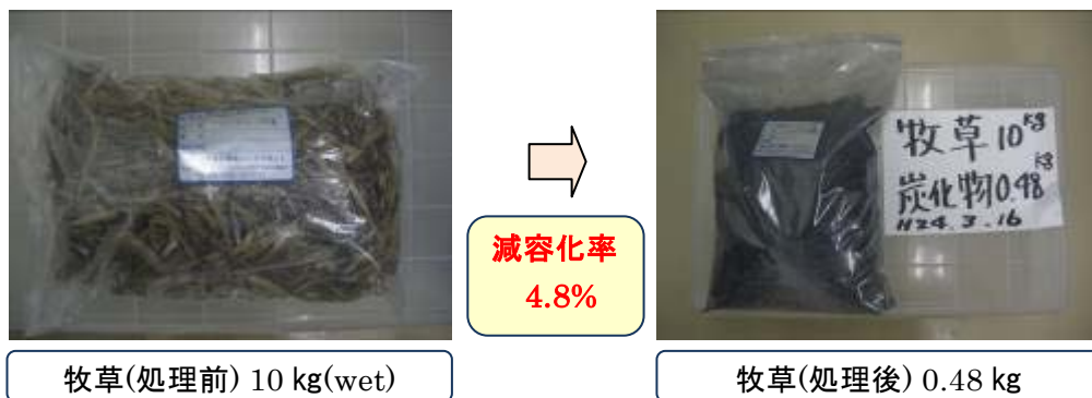
【 図2 炭化処理による汚染牧草の減容化 】
