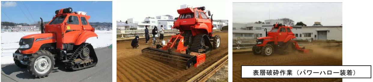
図2 市販農薬散布作業用トラクタ向けキャビンを改造し搭載した開発機（B機）
