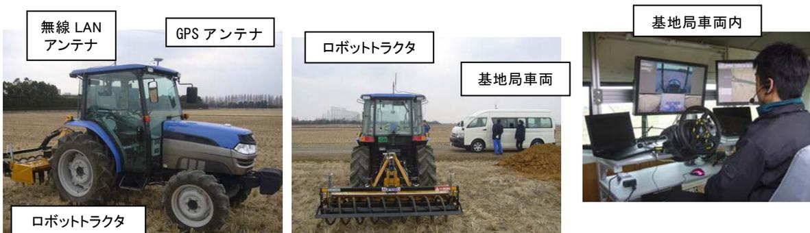
図5 ロボットトラクタに遠隔操作技術を適用した無人作業システム
