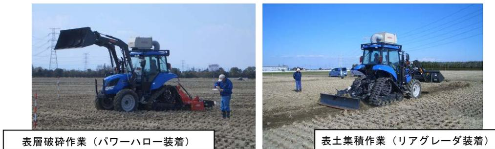
図4 開発機（A機）を用いたほ場内表層土破碎剥離・集積作業
