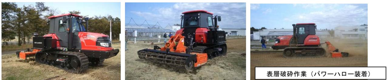
図3 民間企業が開発した放射線遮蔽及び防塵機能を有するトラクタ（C機）
