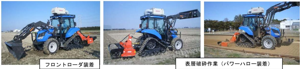
図1 市販農用トラクタのキャビンを改造した開発機（A機）
