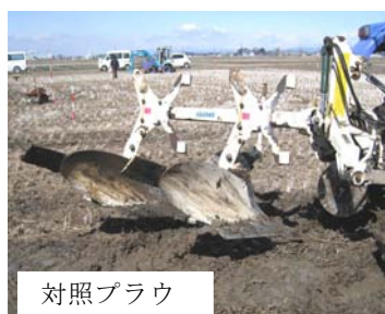
図1 水田用二段耕プラウ(上)と対照プラウ(下)
