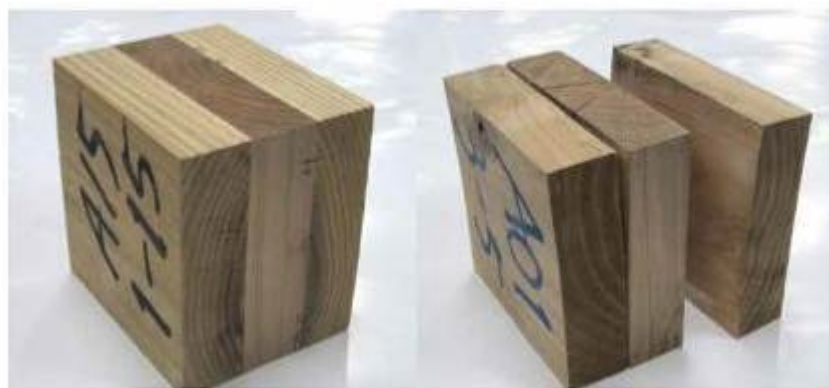
図3 剥離試験による接着不良の検出 左：剥離なし（接着良好） 右：剥離あり（接着不良）
