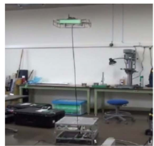
③ MUAVの有線給電 (建設機械周囲の情報取得: ImPACT Project)
