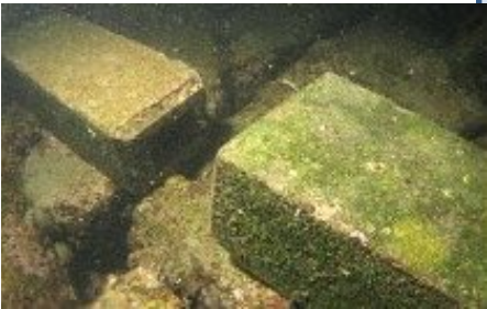
左:一般的なコンクリート 右:アミノ酸コンクリート
