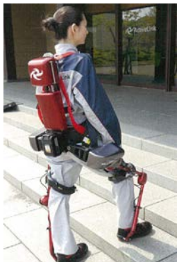
林業分野の知見と工学分野の知見を合わせた 実用的な林業用アシストスーツを開発
