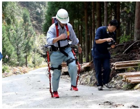
林業分野の知見と工学分野の知見を合わせた 実用的な林業用アシストスーツを開発
