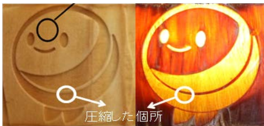
図1. えみか(愛媛大のマスコットキャラクター)での検証実 バックライトを照射した際に、圧縮部位が光透過性を有しているため、高い意匠性を実現している。
