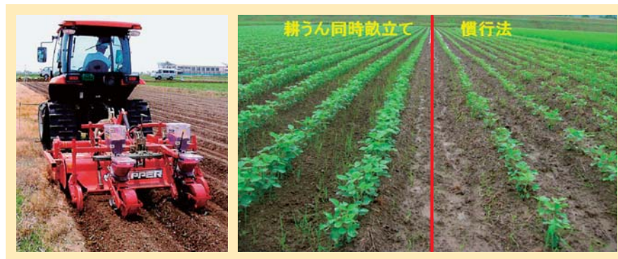
※3 耕うん同時畝立て（大豆の耕うん同時畝立て施肥播種機（左）、耕うん同時畝立て区（中）、慣行区（右））
