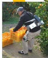
アシストスーツによる作業補助
