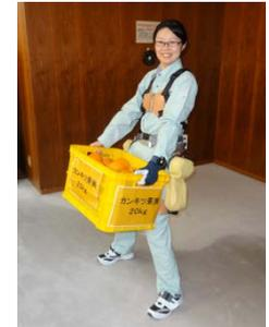
機械化ができない農作業について、人力作業をアシストする農業用パワーアシストスーツを開発中。
