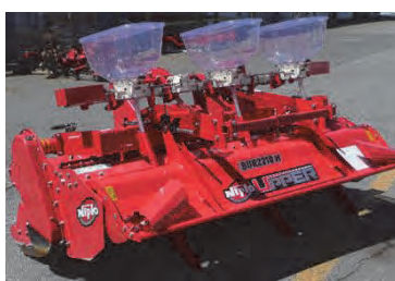
図8 農家所持の既販機へ深層施肥部品の組み込み
