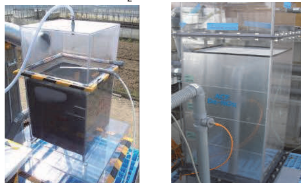
図3 排気浄化システム(左: SO x 用、右NO x 用)
