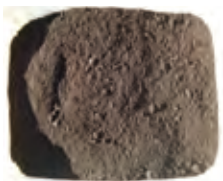
粉末燃料 発熱量=約26~30MJ/kg(石炭並)
