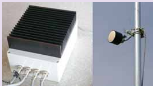
図2 セラミック素子型超音波発生装置
