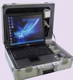
図3 携帯型の牛用BAEP測定・解析装置の試作器
