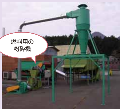
図2 樹皮を燃料とする 小型蒸気ボイラーシステム
