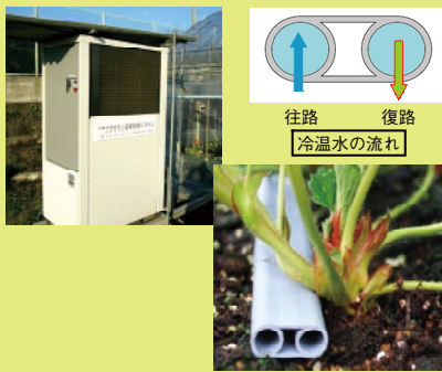
図1 クラウン温度制御装置 冷温水器(上)と2連チューブ(下)
