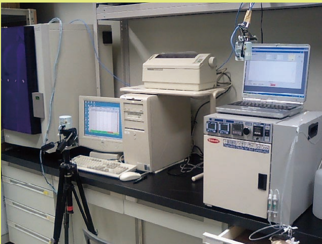
図1 オムニログ・ソイルドック土壌微生物性診断システム
