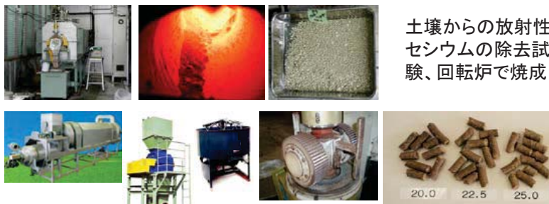
作物残さ・雑草等の乾燥、粉碎、混合、成型によるペレット化による減容化
