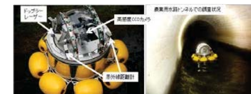
通水中の農業用水路トンネルを点検できる無人調査ロボット
