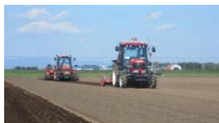
先行する無人トラクタによる耕うんと追従する有人トラクタによる播種
