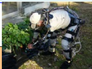
農作業を軽労化するロボットスーツ
