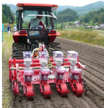
図1 開発した畝立て用ロータリと大豆密植播種(160cm幅)
