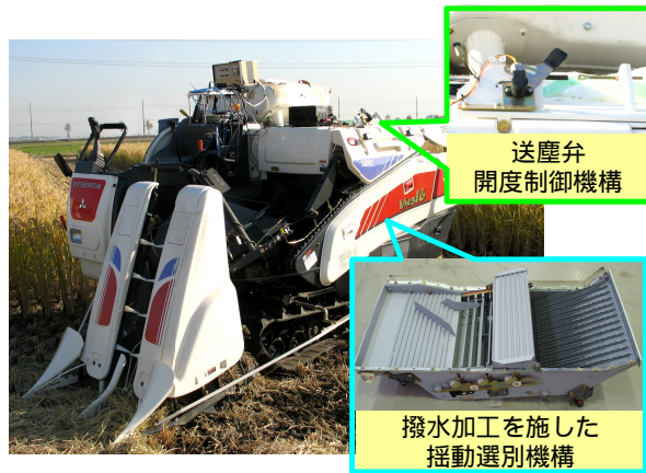
図1 試作機の概要(自脱コンバイン)
