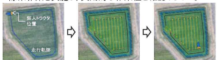
(1)遠隔操縦(走行軌跡記録) (2)作業経路計画の生成 (3)自律運転(遠隔監視)
