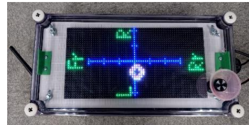
写真5 ハーベスターに取り付けるLEDパネル。丸印がトラックの位置を示し、オペレーターを適切な位置に誘導する
