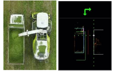
写真4 左：ハーベスターとの協調作業 右：3D-LiDARによるトラック位置の計測
