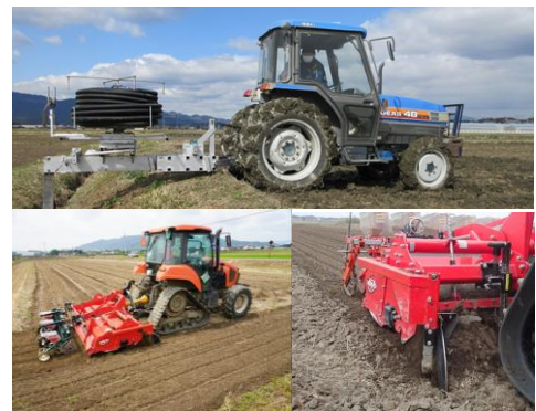
トラクターで施工可能な深い落水口施工装置（写真上） 一工程浅耕播種機（左下）とテスト販売予定のアタッチメント（右下）
